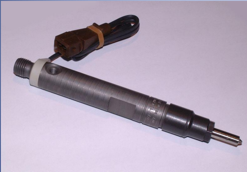
Einspritzdüse mit Nadelbewegungsfühler
